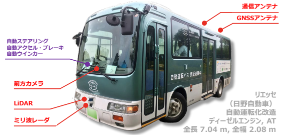
図 3-7 自動運転車両の運転システム概要
