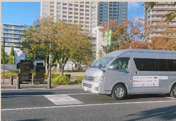
▲左：送電コイルが埋設された道路と実験車両
